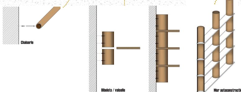
Le mur en autoconstruction, séparant la boutique du reste de l'entrepôt, est fabriqué à partir de tube en carton et de planche de contreplaqué superposé. Cette solution permet de créer une porosité, laissant traverser le regard pour attirer les clients. De plus, des livres, CD, DVD, peuvent être exposés grâce à l'épaisseur du mur.
